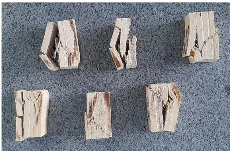
**Figura 4:** Modos de ruptura observados nos CPs de compressão perpendicular às fibras. Fonte: Os autores.
