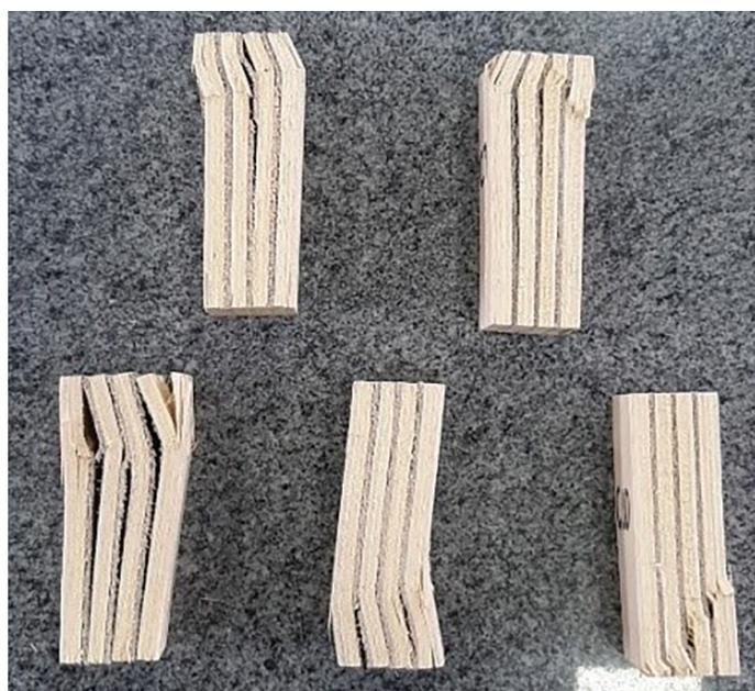
**Figura 3:** Modos de ruptura observados nos CPs de compressão paralela às fibras. Fonte: Os autores.
