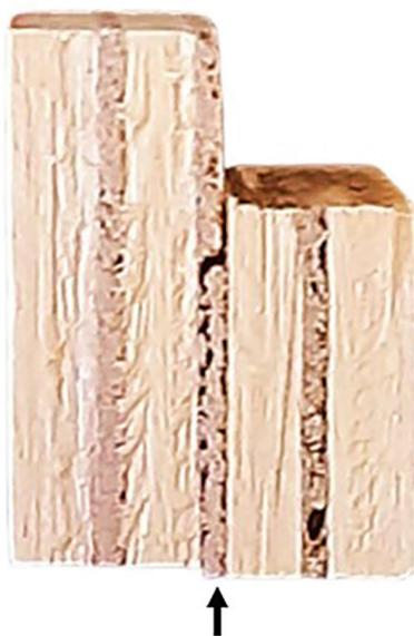
**Lâmina perpendicular à direção de aplicação da carga**
