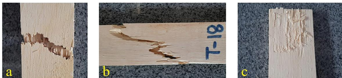
**Figura 5:** Modos de ruptura observados nos CPs de tração paralela às fibras. a) corte das fibras, b) tração da madeira, c) esmagamento e cisalhamento das fibras em contato com o mordente. Fonte: Os autores.
