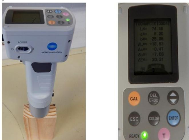
(a) Ensaio sendo realizado na amostra (b) Visor do aparelho com os valores dos parâmetros colorimétricos
