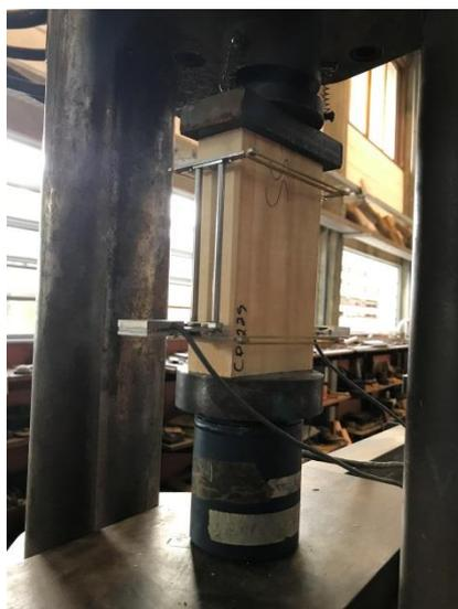
A resistência da madeira na compressão paralela às fibras ( $f_{c0}$ ) é determinada pela relação entre a máxima força de compressão ( $F_{c0,máx}$ ) e a área da seção transversal ( $A$ ), como expressa a Equação 1.
