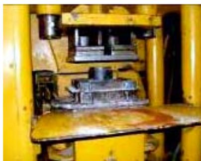
dráulicos para se estabelecer um procedimento de produção e se obter de uma dosagem inicial do ladrilho hidráulico que fizesse com que os mesmos fossem desformados sem quebras, sendo adotadas para a camada inferior a dosagem 1:3 (cimento:material seco) e para a camada intermediária a dosagem 1:2 (cimento:resíduo), ambas em massa.
