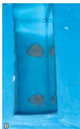
FIGURA 4 - Após a colocação dos dentes nos respectivos locais, manipulou-se a resina com propriedade fotoelástica e inseriu-a nos negativos para obtenção do modelo fotoelástico.
