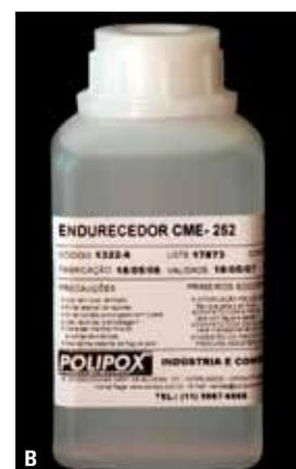
FIGURA 5 - Vista da resina EPOXI, CRM-201 flexível e do endurecedor CME-252 flexível.
