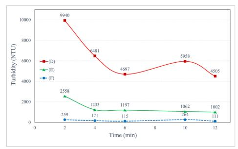
Figure 2 - Turbidity curves of quartz -38+10μm, pH 11.0, 0.2% solids, 550 rpm. (D) blank, (E) 300 g/t PAM + 1.6x10<sup>-3</sup> mol.L<sup>-1</sup> EDA, (F) 30 g/t PAM + 3.2x10<sup>-5</sup> mol.L<sup>-1</sup> EDA.
