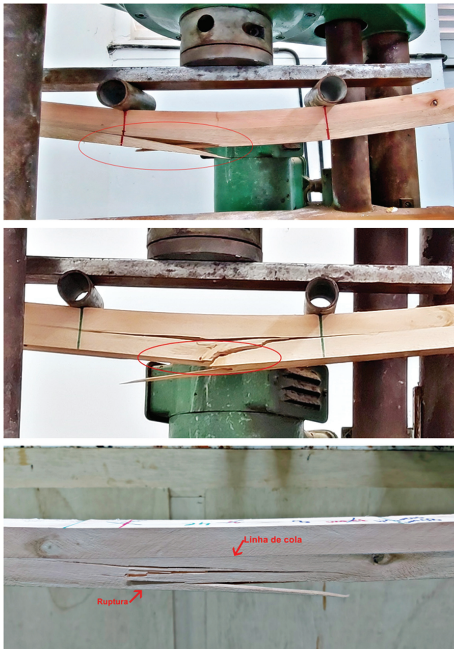
Figura 5: Rupturas dos corpos de prova à flexão de 4 pontos.
