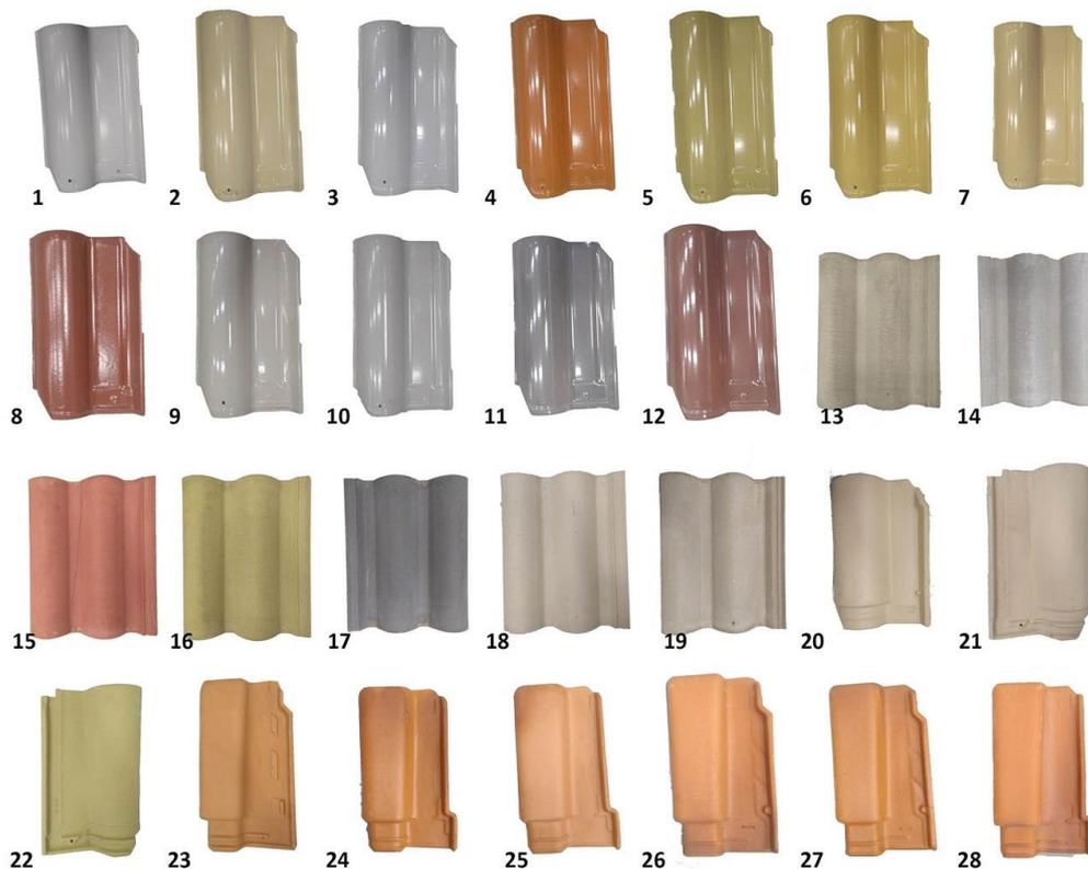
Figura 2 - Amostras extraídas das telhas para exposição ao tempo
