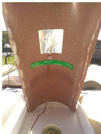
(b) Ligação do termopar do tipo T na telha
