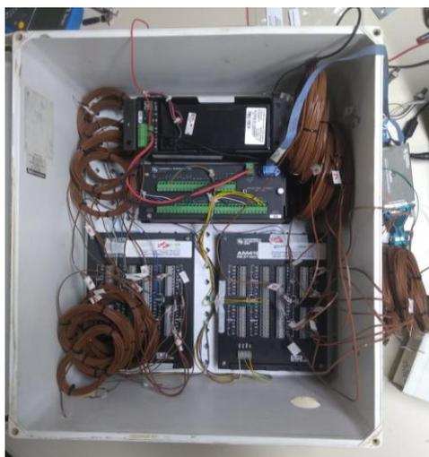
(a) Sistema de aquisição dos dados
