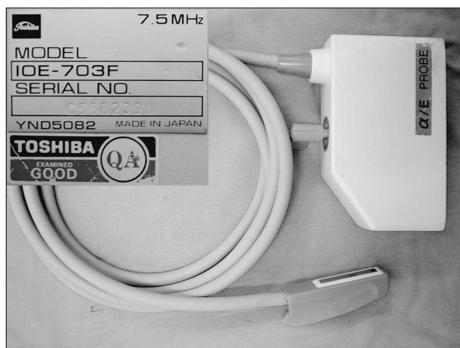
FIGURA 3. Transdutor IOE – 703F de 7,5 MHz
