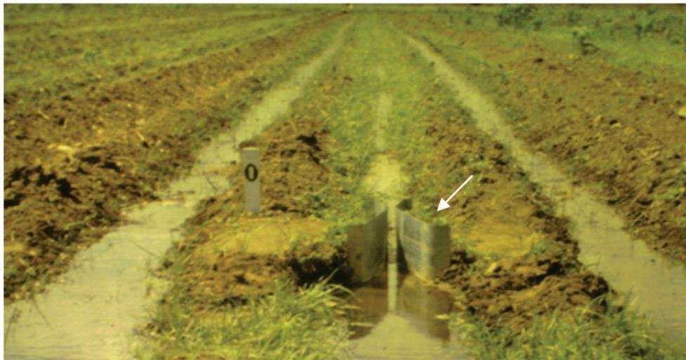
Figura 1. Calha Parshall instalada no início do sulco.
