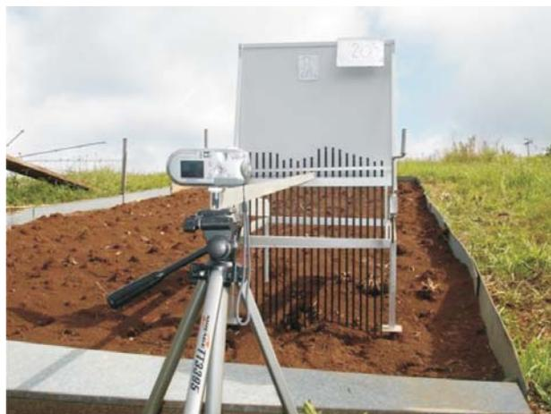
Figura 2. Rugosímetro em operação.
