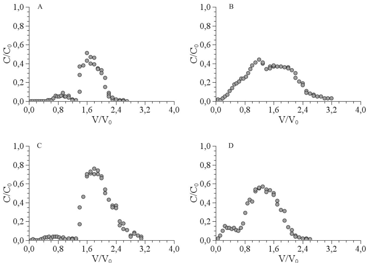
**Figura 2.** Curvas de transposição de nitrato, em Latossolo Vermelho Acriférico com adição de fosfatos e sulfatos (Experimento II): A, LV-B; B, SULF; C, ACID-FOSF; D, BASE-FOSF.
