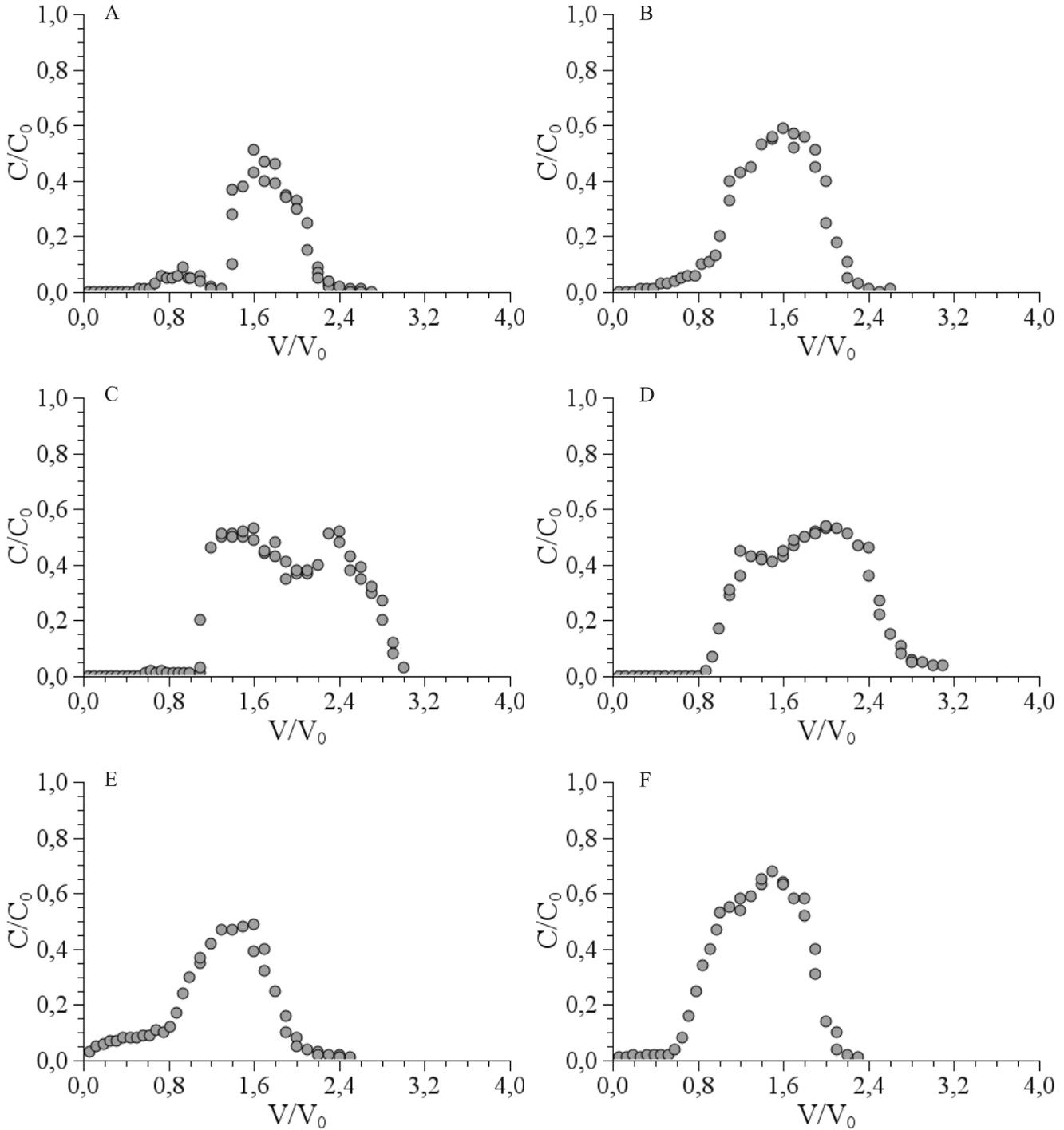
**Figura 3.** Curvas de transposição de nitrato, em Latossolo Vermelho Acriférrico, submetido a pulsos com diferentes forças iônicas (Experimento III): A, LV-B; B, CONC; C, ACID2; D, ACID-CONC; E, BASE2 e F, BASE-CONC.
