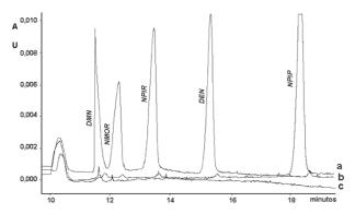
Figura 3. Eletroferogramas resultantes da análise de 200 mL de uma amostra sintética (1000 µg L<sup>-1</sup>) fracionada por EFS: (a) eluato com acetona, (b) eluato com diclorometano e (c) água residual analisada diretamente
