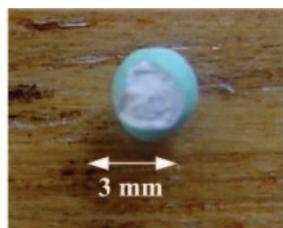
**Figura 5.** Fotografia da NaX depois de empregada no sistema refluxo a 50 °C por 4 h
