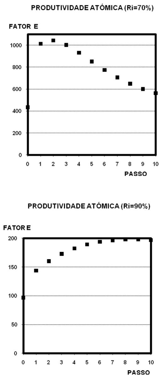
**Figura 3.** Variação do fator E em função da posição do passo com fator de diluição aumentado (10 x) no Exemplo 2. Valores do rendimento individual de todos os passos (valor constante da economia atômica entre parêntesis): em cima, 70% (EA = 7,3 %); em baixo, 90% (EA = 51,0%)
