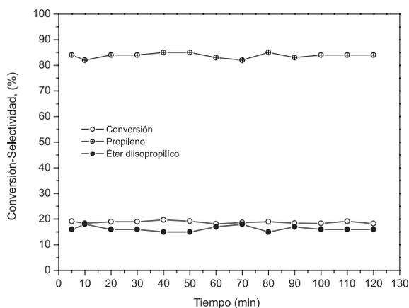
Figura 5. Descomposición de 2-propanol con el material  $\text{ZrO}_2\text{-H}_3\text{PW}_{12}\text{O}_{40}$ . Condiciones de reacción:  $T = 90\text{ }^\circ\text{C}$ ,  $P = 1\text{ atm}$  y  $\text{WHSV} = 10\text{ h}^{-1}$
