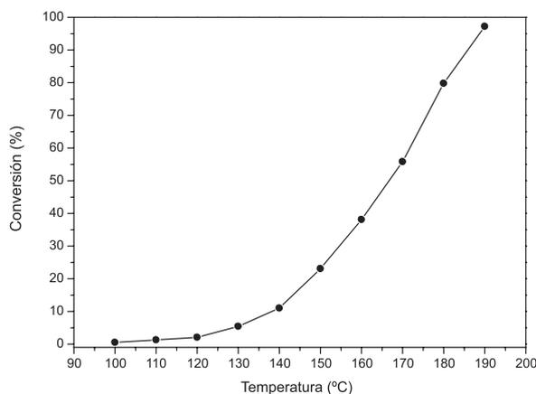
Figura 6. Efecto de la temperatura de reacción en la conversión de 2-propanol utilizando el  $\text{ZrO}_2$  como catalizador. Condiciones de reacción:  $P = 1\text{ atm}$  y  $\text{WHSV} = 10\text{ h}^{-1}$
