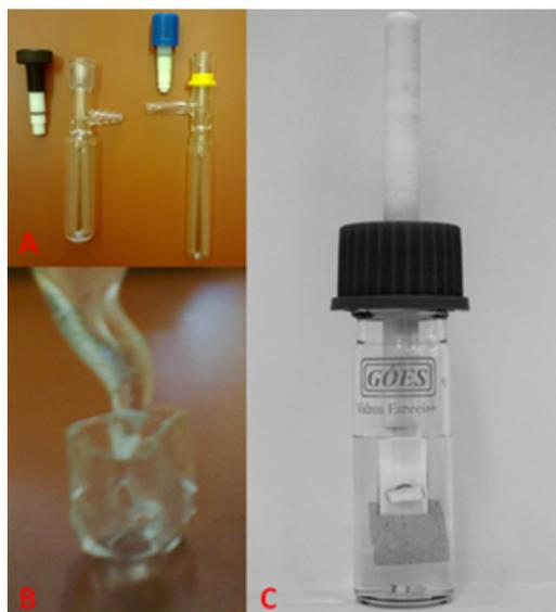
**Figura 1.** A) Reator de Schlenk com selo de PTFE; B) Detalhe do cesto para catalisador tipo “dip catalyst”; C) Reator GDCR otimizado com prendedor para filme contendo nanopartículas metálicas pronto para o uso
