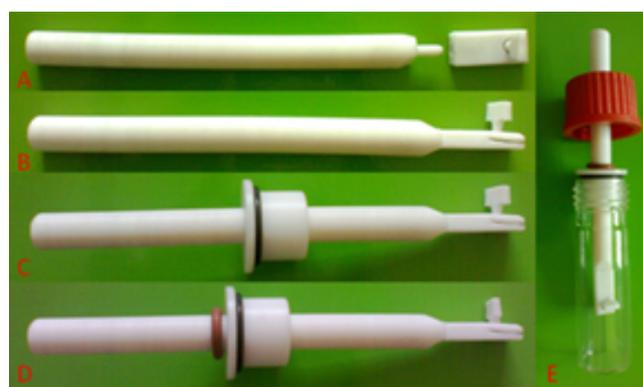
**Figura 3.** Montagem do reator GDCR
