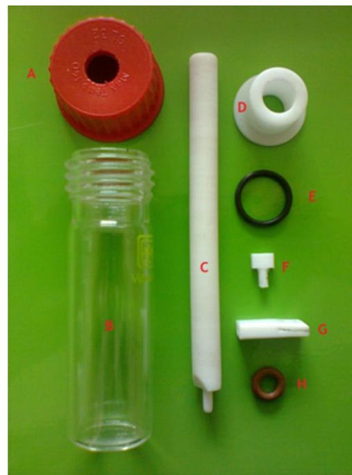
**Figura 2.** Peças do reator GDCR tipo “dip catalyst”
