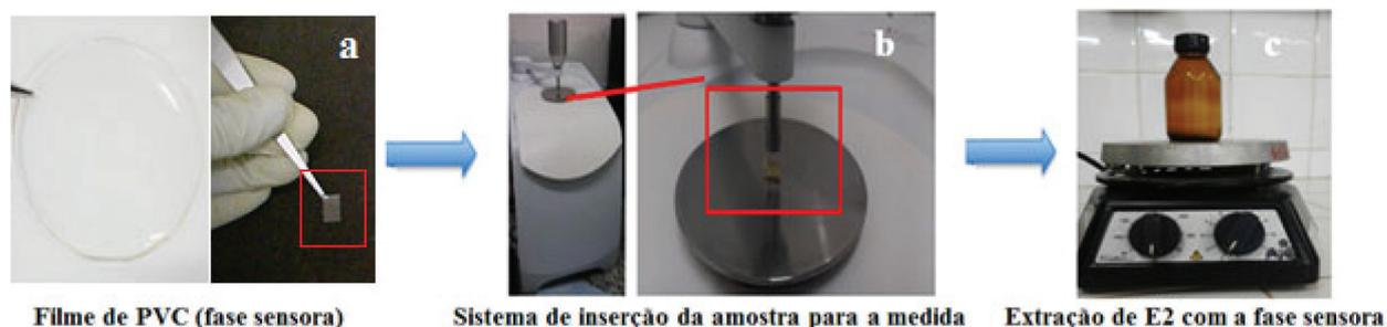
**Figura 1.** Esquema do procedimento realizado para obtenção dos dados. (a) corte da fase sensora, (b) análise espectroscópica na UATR e (c) meio aquoso sob agitação onde a fase sensora era exposta por tempo determinado
