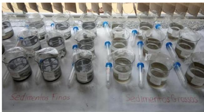
**Figura 3.** Bancada com o experimento de acidificação (seqüências de béqueres com sedimentos grossos e finos)
