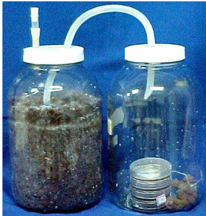
**Figura 1.** Mecanismo utilizado para simular o processo de solarização – conjunto de microcosmo.
