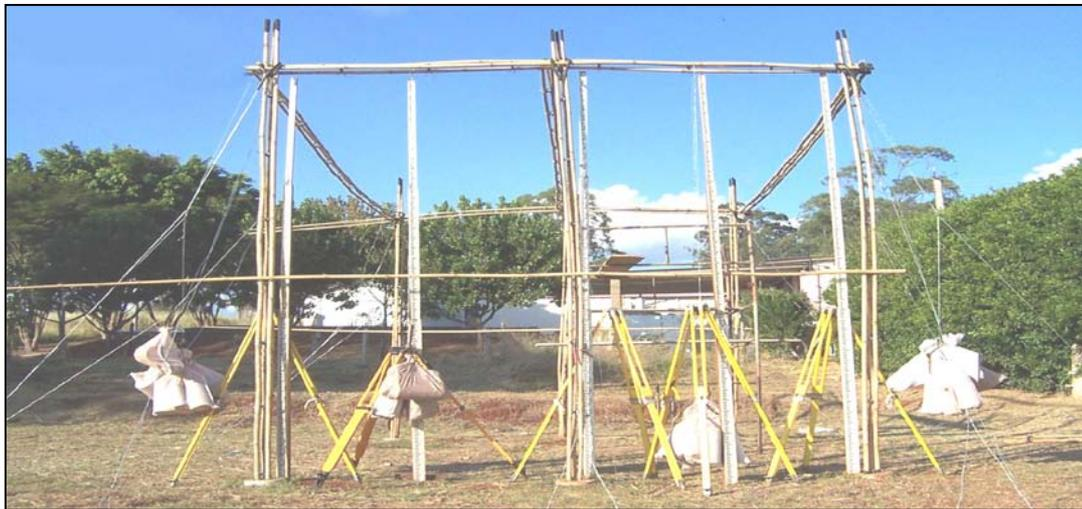
FIGURA 3. Croquis e foto do ensaio de campo da distribuição das cargas aplicadas e os pontos de medição dos deslocamentos no pórtico longitudinal.
