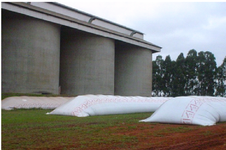
FIGURA 1. Silos tipo bolsa instalados na Cooperativa Agrária, Guarapuava - PR. Bag type silos installed inat Cooperativa Agrária, Guarapuava - PR, Brazil.
