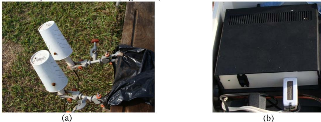
FIGURA 2. (a) sensores de T e UR em cilindros vazados de proteção; (b) aspecto final do circuito do SAD montado em caixa plástica. (a) **Temperature and Relative Humidity sensors in protective leaked cylinder**, (b) **final aspect of DAS circuit mounted in a plastic box**.
