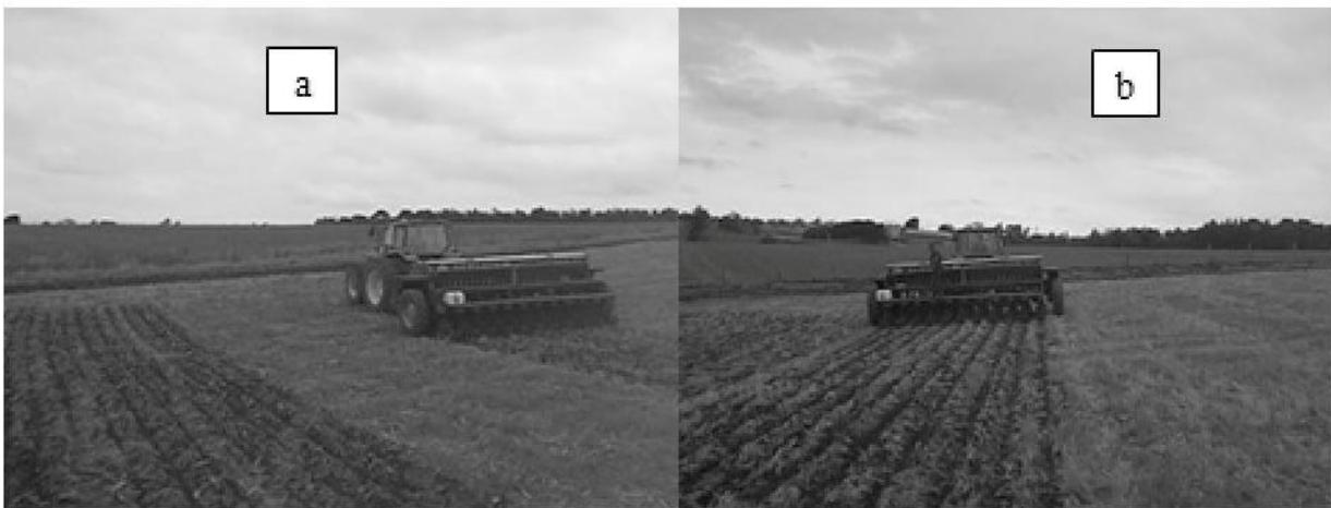
FIGURA 1. Manobra com piloto automático em faixas de semeadura alternadas (a); e manobra convencional, com semeadura em faixas sequenciais (b). **Maneuver with the aid of an autopilot device in alternating rows (a) and conventional maneuvers in sequential rows (b).**
