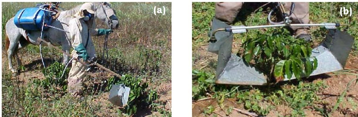
Figura 1 - Pulverizador para aplicação de herbicidas (a) e barra de pulverização com o dispositivo protetor contra deriva (b).
