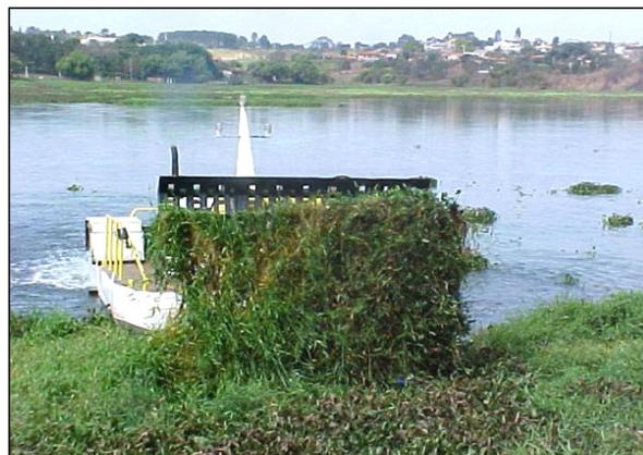
*Figura 3* - Detalhe da embarcação encaminhando plantas aquáticas até a esteira.
