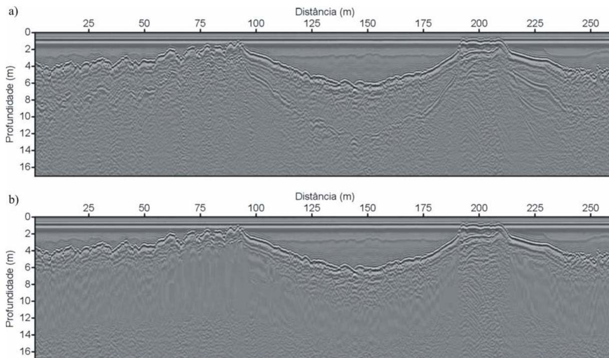
**Figura 11** – Seção GPR de 100 MHz adquirida no sentido transversal ao Rio Taquari, localizada nas proximidades da Fazenda Santa Maria. Seção processada sem a deconvolução em a), e seção obtida após a DP multicanal “por partes” em b).
