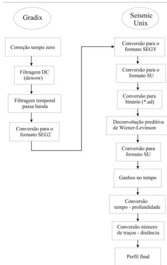
Figura 6 – Fluxograma usado no processamento dos dados.
