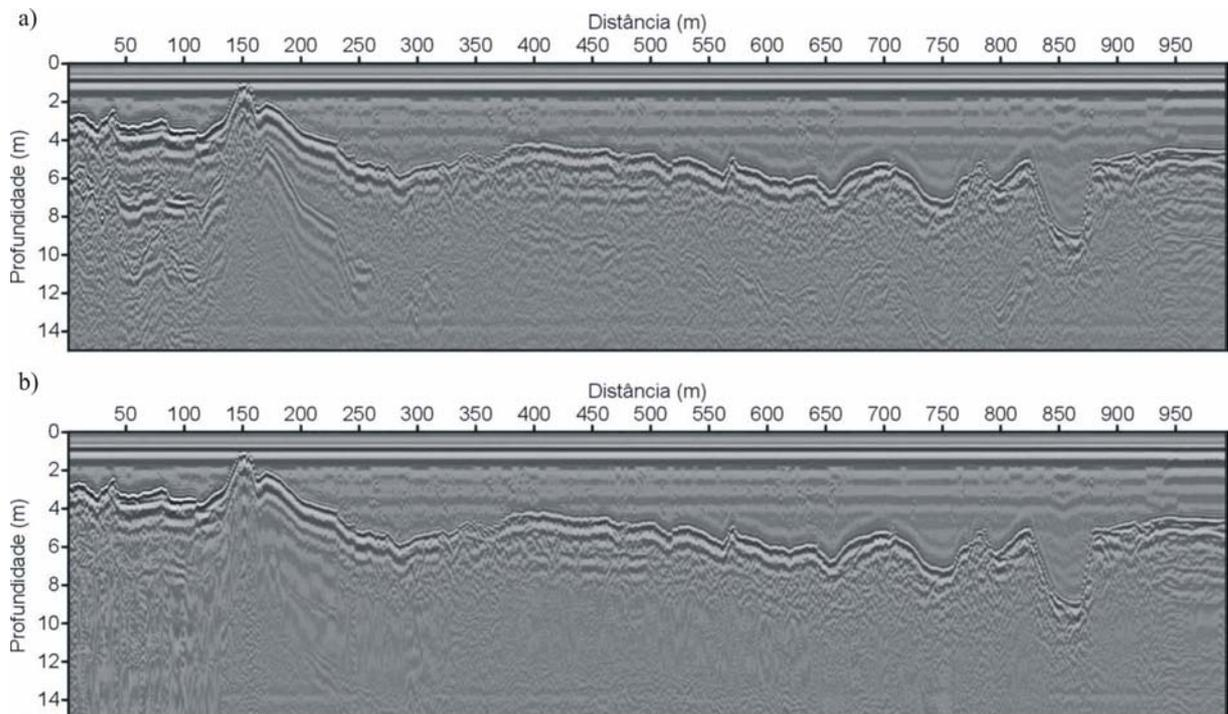
**Figura 12** – Seção GPR de 100 MHz adquirida ao longo do Rio Taquari nas proximidades do Porto Santa Luzia, onde estão ocorrendo as avulsões. Seção processada sem a deconvolução em a) e a Seção obtida após a DP multicanal “por partes” em b).
