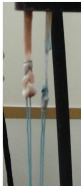
**Fig. 10 – Região de falha na sutura no ensaio de tração.**
