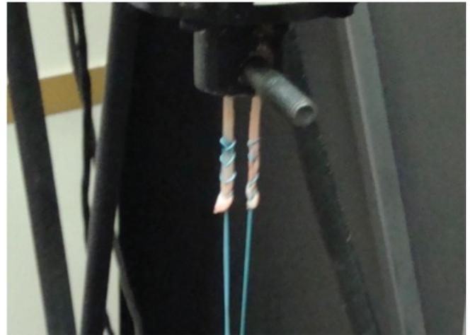
**Fig. 8 – Corpo de prova posicionado na máquina de tração em cavaleiro.**
