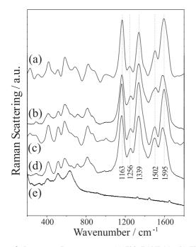
Figure 3. Resonance Raman spectra: (a)  $TiO_2/PANI-1A$ ; (b)  $TiO_2/PANI-1B$ ; (c)  $TiO_2/PANI-2A$ ; (d)  $TiO_2/PANI-2B$ ; (e)  $TiO_2$ .
