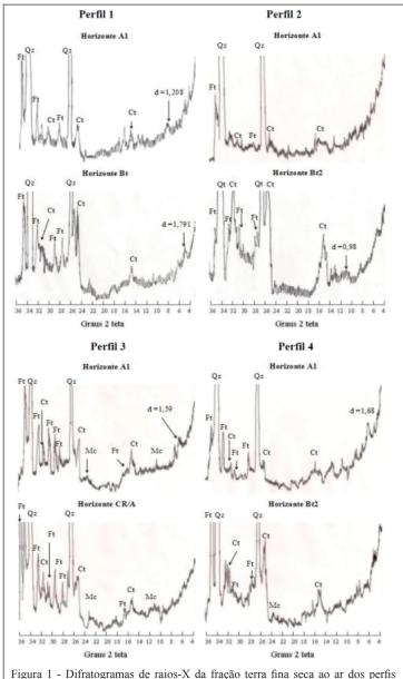
Figura 1 - Difratogramas de raios-X da fração terra fina seca ao ar dos perfis de solos. Ct- caulinita, Qz- quartzo, Ft- feldspato, Mc= Mica, d=distância planar.
