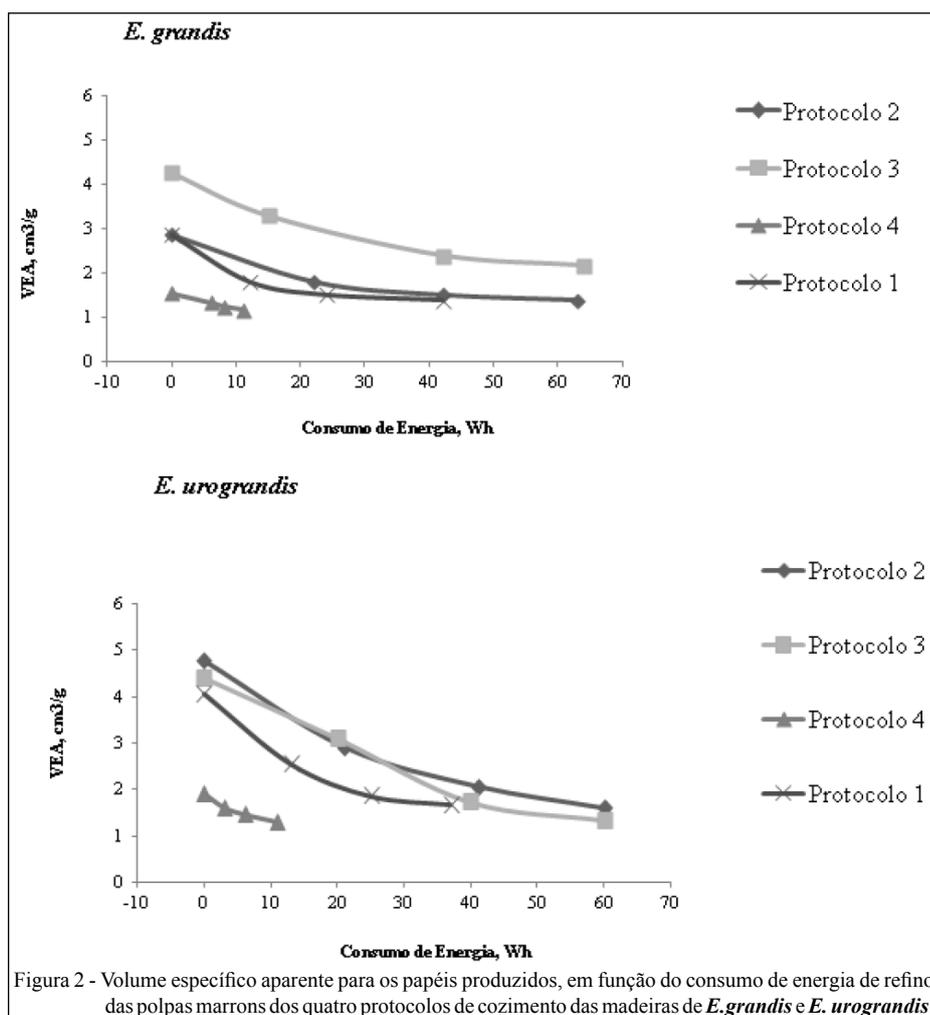
Figura 2 - Volume específico aparente para os papéis produzidos, em função do consumo de energia de refino das polpas marrons dos quatro protocolos de cozimento das madeiras de *E. grandis* e *E. urograndis*.
