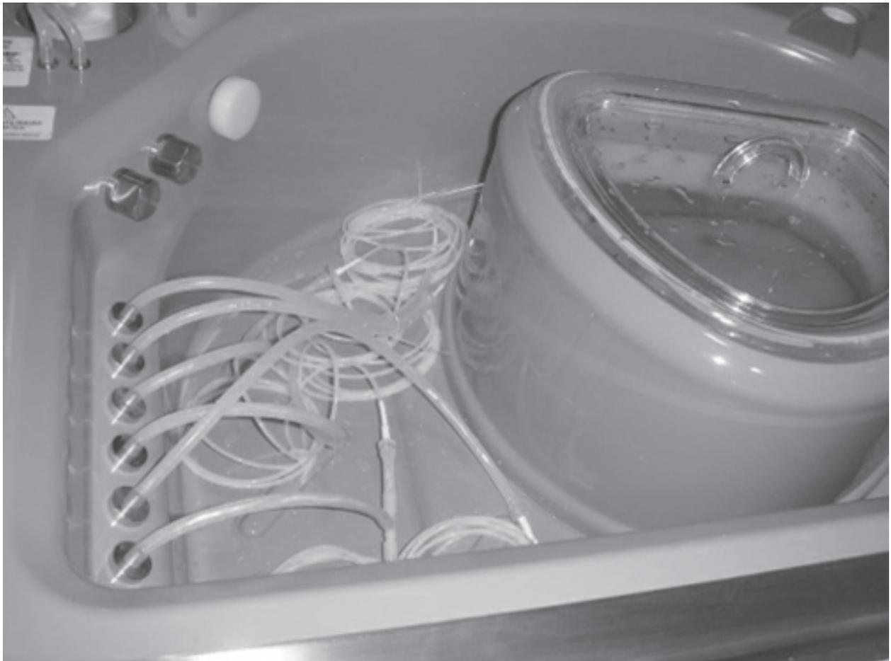
Figura 1 - Corpos de prova encaixados nos conectores da processadora automática de endoscópios flexíveis em teste.
