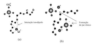
Figura 1 - Representação da interação entre uma cadeia polimérica tipo POE e o cátion (a) e formação de par iônico (b) em sistemas eletrólitos poliméricos.
