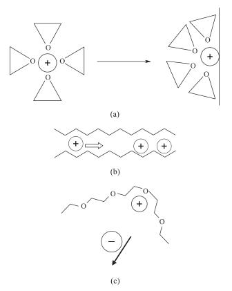
**Figura 2.** Modelos esquemáticos para mecanismos de condução iônica em líquidos (a), sólidos cristalinos ou vítreos (b) e polímeros (c)
