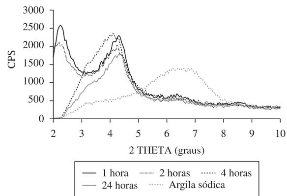
Figura 3. Modificação da argila sódica:cetilpiridíneo na proporção 2:1.
