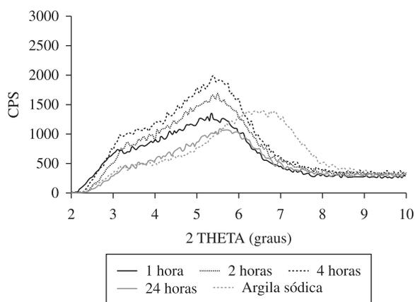
Figura 1. Modificação da argila sódica:cetilpiridíneo na proporção 6:1.
