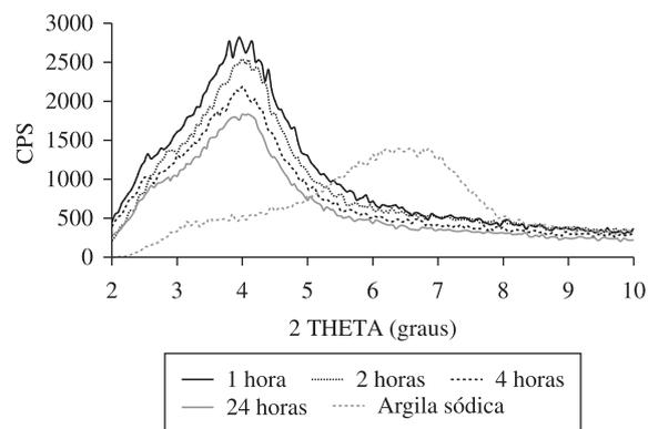
Figura 2. Modificação da argila sódica:cetilpiridíneo na proporção 3:1.
