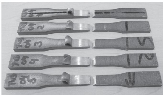
Figura 8. Corpos de prova após ensaio de tração. Fraturas localizadas na ZTMA do lado de avanço.
