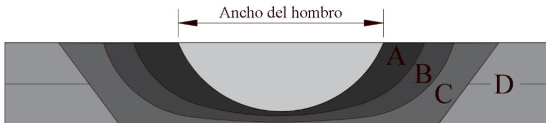
**Figura 2.** Diferentes zonas de una unión producida por el proceso FSW. (A): Zona de Agitación, (B): Zona Afectada Termomecánicamente, (C): Zona Afectada por el Calor y (D): Metal Base.
