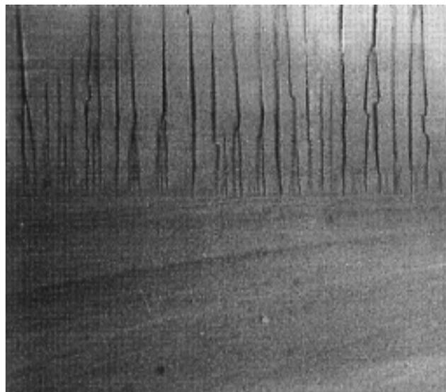
Figura 6: Superfície de fratura de uma placa de vidro submetida à flexão. As ramificações de rotação (“twist hackle”) são vistas na parte superior da figura. Microscopia ótica (Mag. X50) [2].
