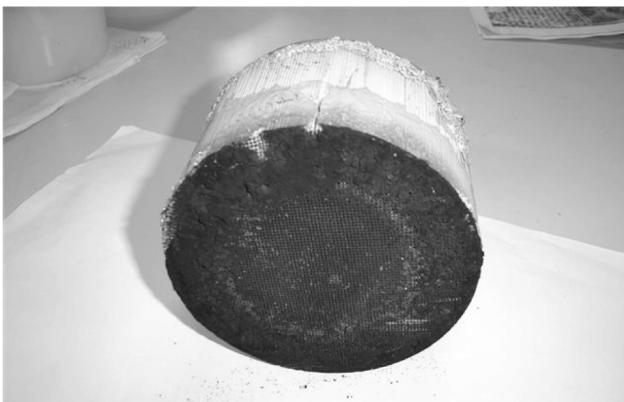
Figura 9: Catalisador usado totalmente contaminado com fuligem.
