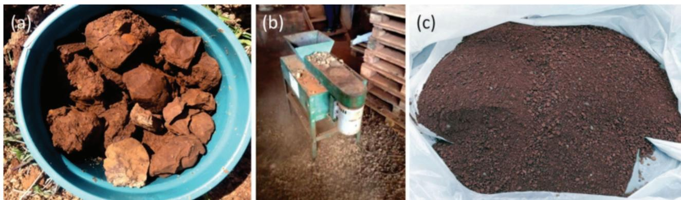
Figura 2: Resíduo após sua remoção (a), trituração em máquina tipo pedra moinho (b) e triturado (c).
