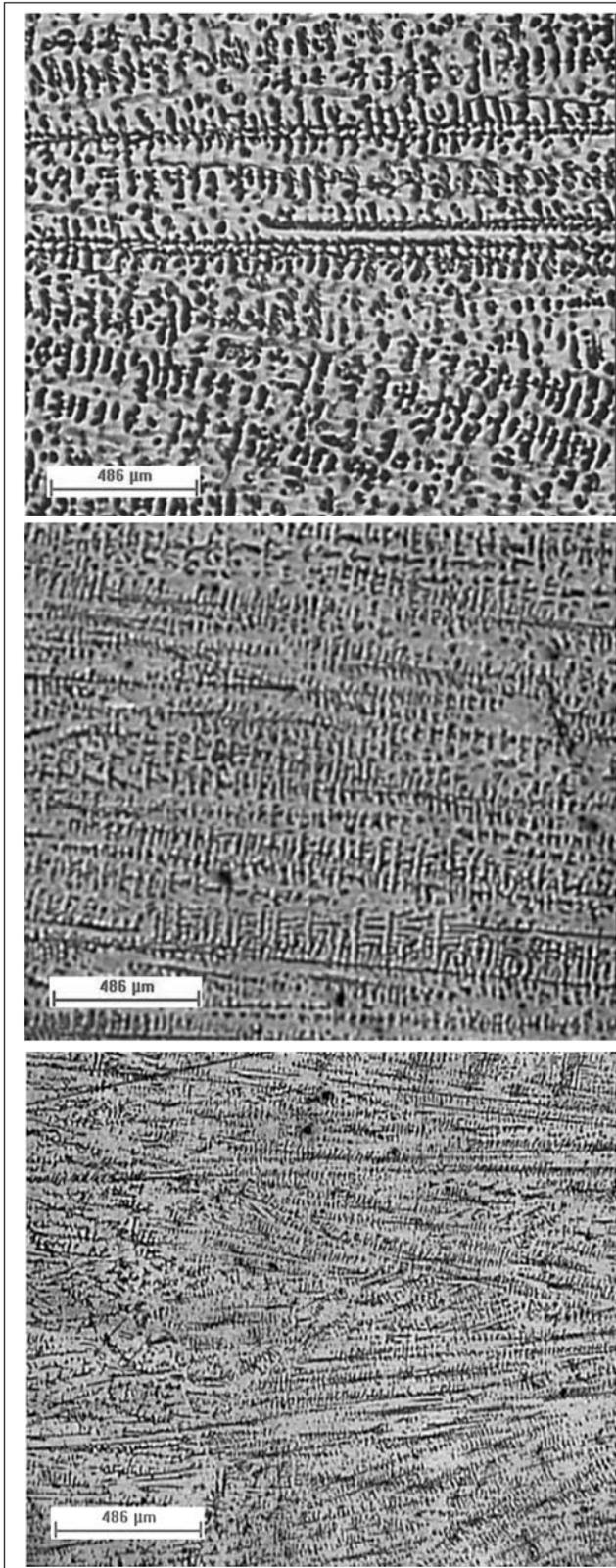
**Figura 5** - Micrografias do aço inoxidável AISI 304 solidificado unidirecionalmente, seção longitudinal mostrando a variação dos espaçamentos com a distância da coquilha de cobre refrigerada. Ataque Marble. (a) Distante 30 μm da coquilha. (b) Distante 10 μm da coquilha. (c) Distante 1 μm da coquilha.
