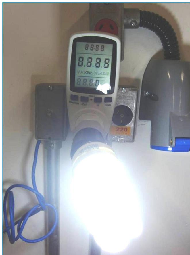
Figura 3 - Lâmpada fluorescente em teste.
