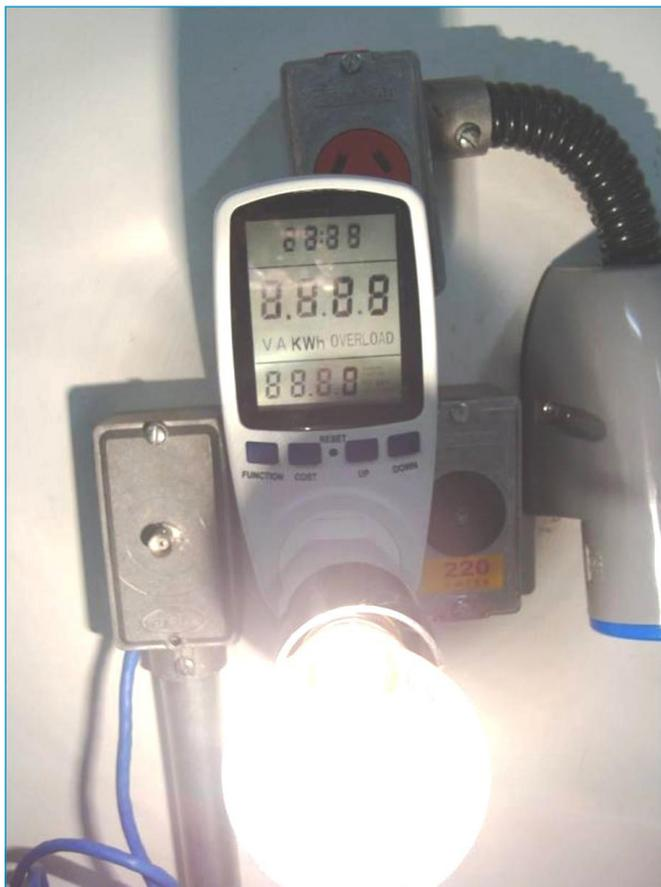
Figura 4 - Lâmpada incandescente em teste.
