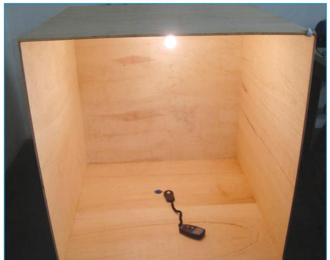
Figura 7 - Teste de luminosidade com a lâmpada LED.
