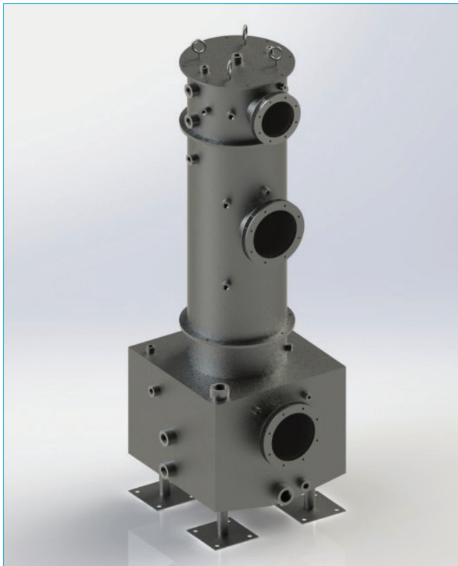
Figura 3 - Isométrica lateral da torre de absorção.
