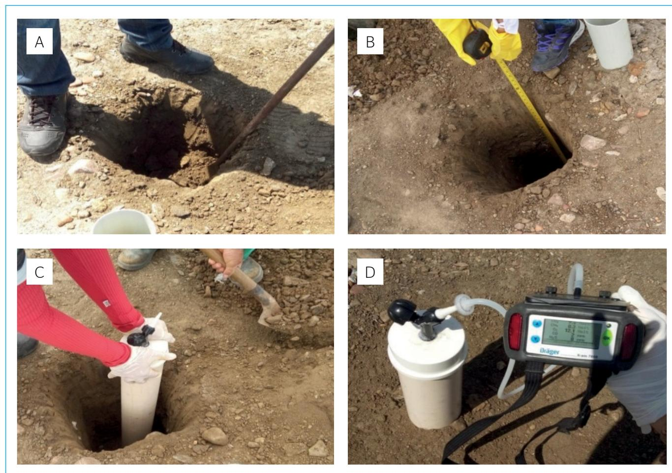
**Figura 4** - Estudo da concentração de gases na interface solo-resíduo: (A) início da sondagem superficial; (B) finalização da sondagem e medição da espessura da *liner*; (C) instalação do dispositivo de medição de concentração de gases (DMC); (D) monitoramento da concentração de gases.
