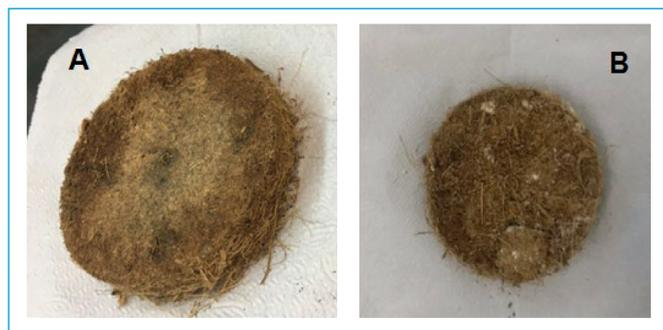
**Figura 4** - Briquete feito (A) com água e (B) e com amido.
