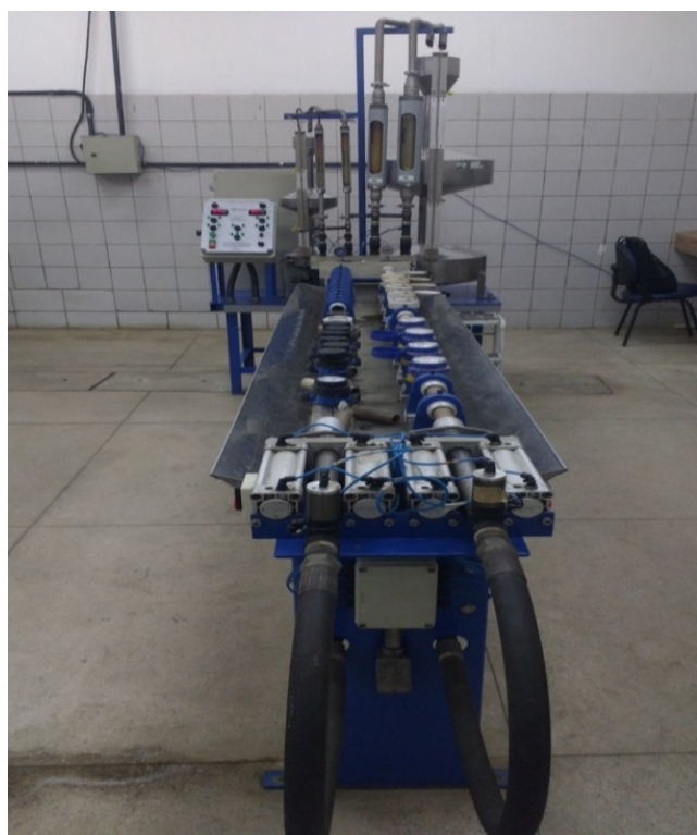
Figura 1 – Bancada de calibração de hidrômetros da Companhia Pernambucana de Saneamento (COMPESA).
