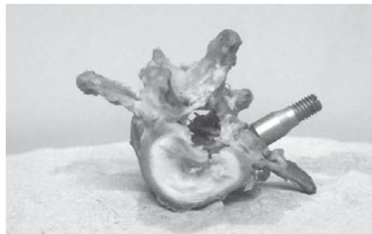
**Figura 2B** - Vértebra após o teste de arrancamento do parafuso, notando a ruptura das corticais.
