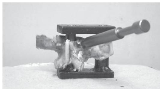
**Figura 3** - Dispositivo de fixação do parafuso na máquina de ensaio para o teste de arrancamento.
