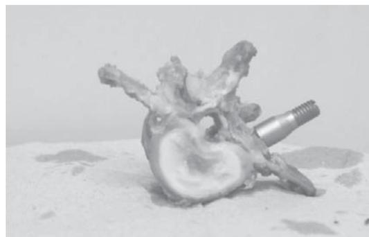
**Figura 2A** - Vértebra com o parafuso pedicular antes do teste de arrancamento.
