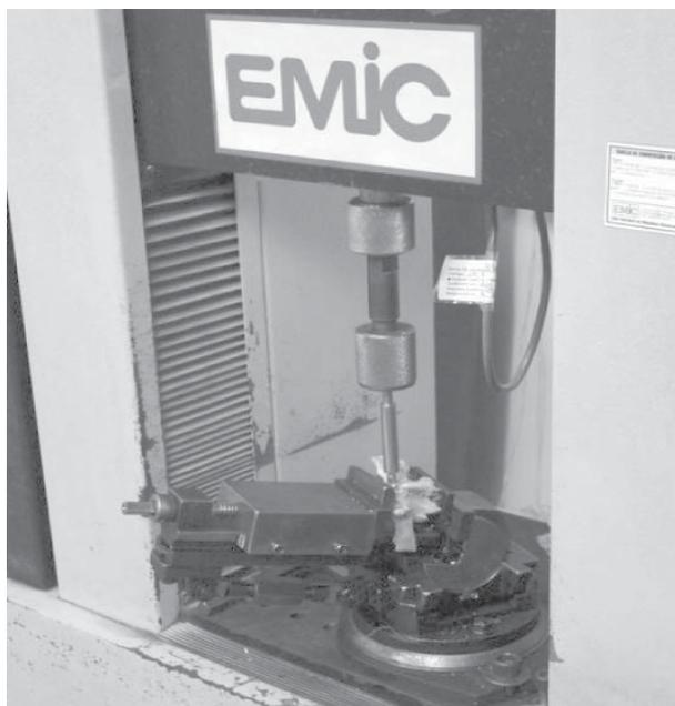
**Figura 1** - Máquina universal de ensaio para teste da força de arrancamento dos parafusos pediculares.
