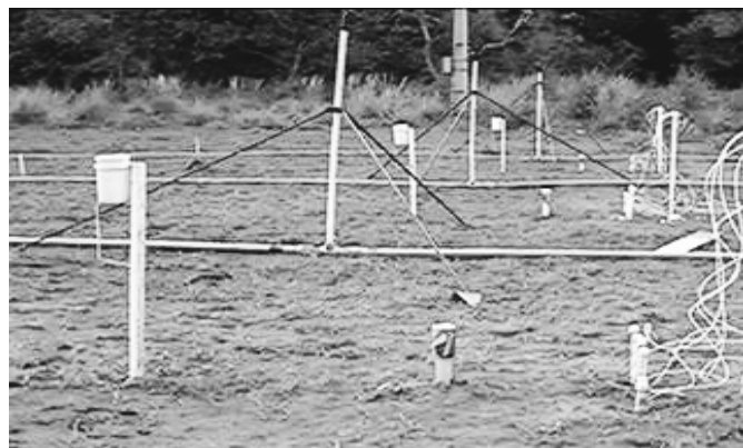
Figura 1. Tubo de acesso (centro), coletor (esquerda) e bateria de tensiômetros (direita)
