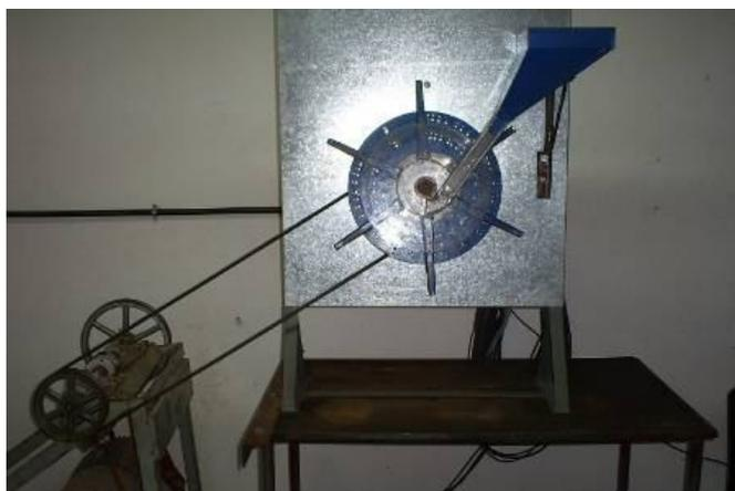
**Figura 2.** Bancada de testes com a roda puncionadora que incorpora os sistemas dosador e distribuidor de sementes
