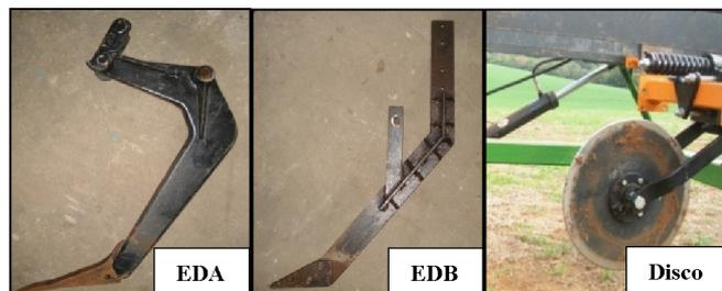
**Figura 2.** Ilustração dos dois elementos descompactadores, EDA (comercial), EDB (experimental) e o Disco de corte de palha
