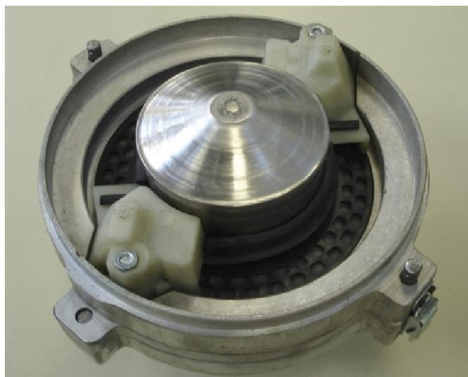
**Figura 3.** Protótipo do dosador de sementes de disco horizontal com dupla saída
