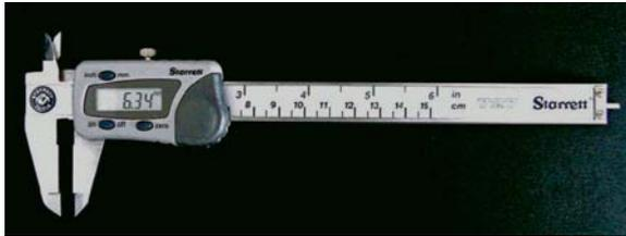
FIGURA 1 – Paquímetro digital.
